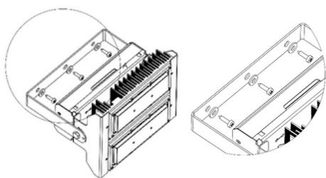
**OBS.:** Para a fixação, sugere-se o uso de parafusos de Inox, arruela dentada e, em casos de estrutura metálica, que a mesma esteja isenta de ferrugem. Certifique-se de que todos os orifícios disponíveis na alça estejam sendo utilizados por parafusos, que os mesmos estejam bem apertados e que o equipamento esteja firme.
